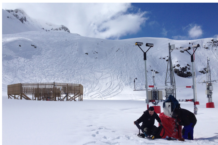
Fig. 1: Instalación de los disdrómetros OTT Parsivel en la estación de esquí de ARAMON-Formigal, con el doble vallado del patrón internacional de medida de la precipitación al fondo.
