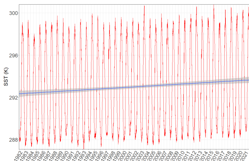
Fig. 3: Evolución temporal de la serie diaria de SST media del Mediterráneo (línea roja) y su tendencia lineal (línea azul) en el periodo 1982-2021.
