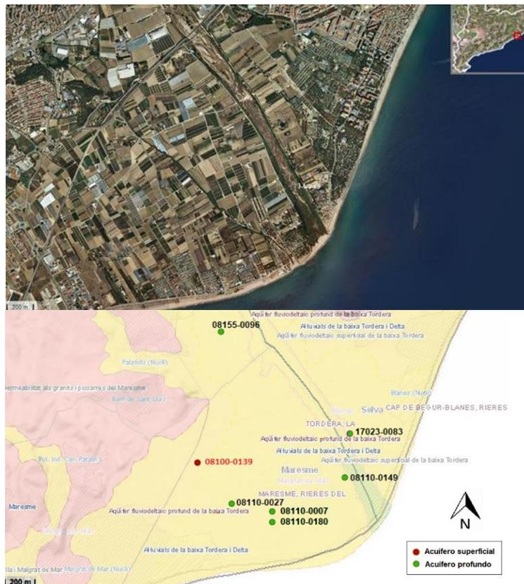
Fig. 2: Imagen espacial del área de estudio y de la distribución de los piezómetros. Los códigos representan el identificador de cada piezómetro. Fuente: aplicación VISSIR del ICGC.
