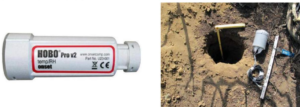
Fig. 3: Termohigrómetro del aire U23-001 HOBO® Pro v2 Temp/RH (izquierda) y registrador HOBO® U12 de 4 Canales con el sensor de temperatura TMC6-HD y de humedad del suelo ECH<sub>2</sub>O EA10 (derecha).
