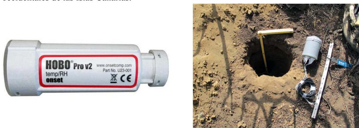
Fig. 3: Termohigrómetro del aire U23-001 HOBO® Pro v2 Temp/RH (izquierda) y registrador HOBO® U12 de 4 Canales con el sensor de temperatura TMC6-HD y de humedad del suelo ECH 2 O EA10 (derecha).
