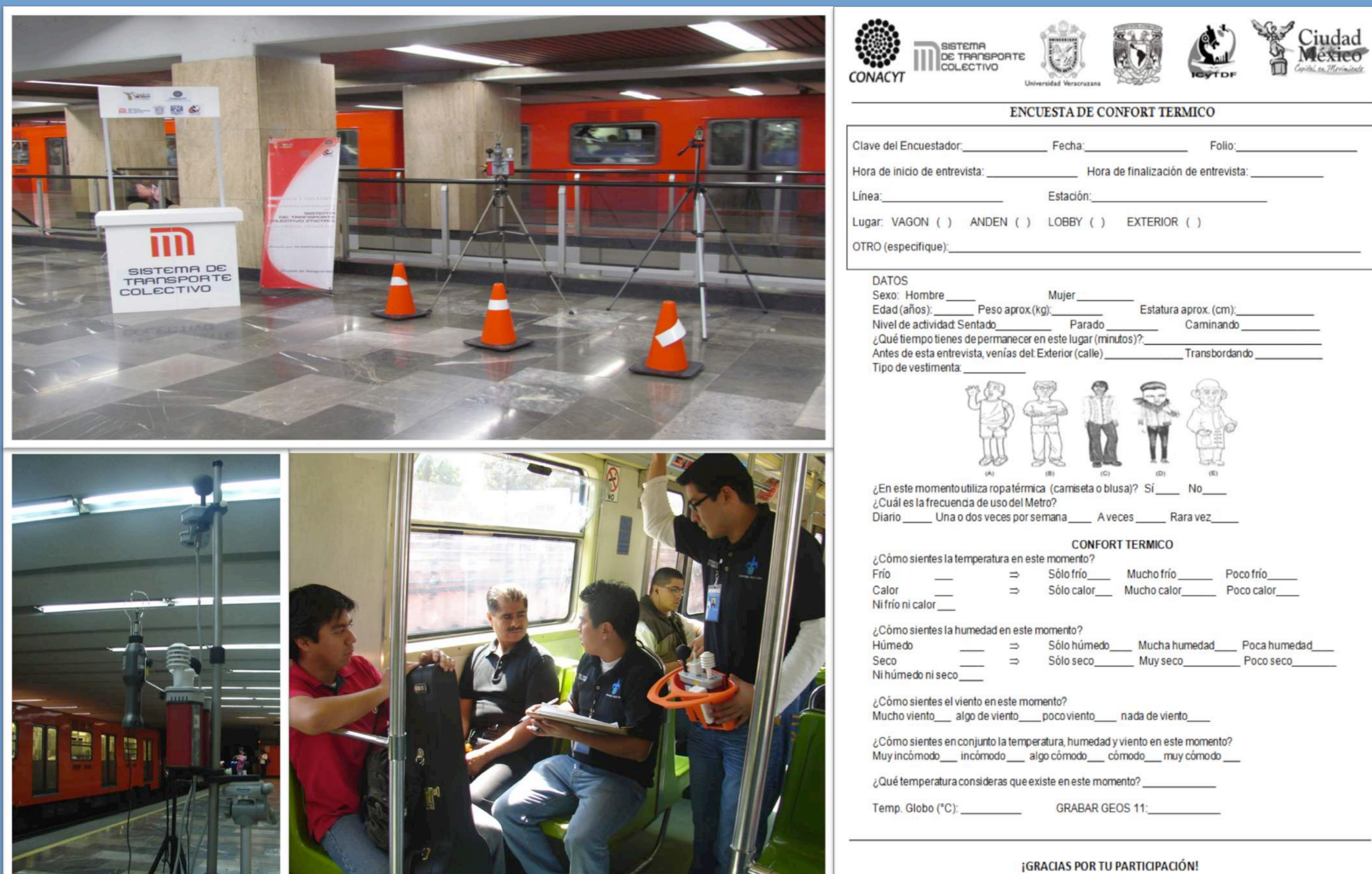
Fig. 1 Mediciones de temperatura en lobby, andén y vagón. Encuesta de confort térmico humano para los usuarios del Metro (9500 en total).
