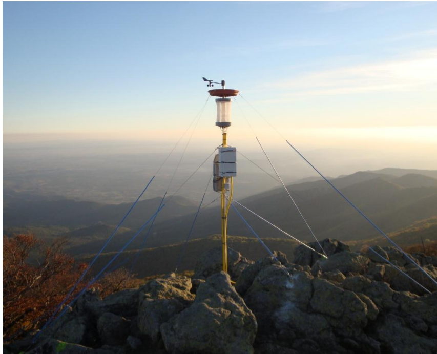
Fig. 2: Equipo para la recolección de niebla instalado en la cima del Puig Neulós. El colector de niebla, de forma cilíndrica, se encuentra instalado en la parte superior del equipo, justo debajo de los sensores de viento y del protector de lluvia (plato naranja)
